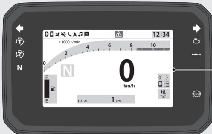
No utilice las funciones de la pantalla durante mucho tiempo con el motor parado. Podría descargar (o agotar) la batería.
