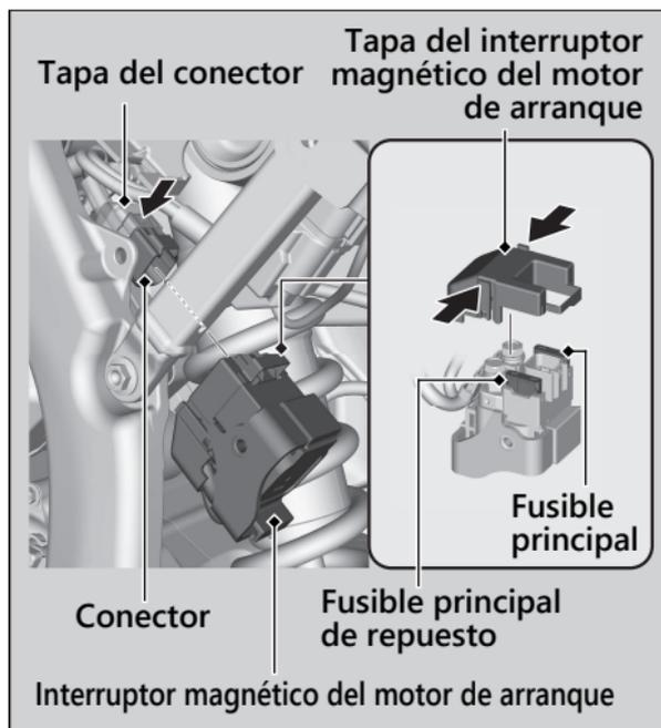
9. Instale la tapa del interruptor magnético del motor de arranque.
