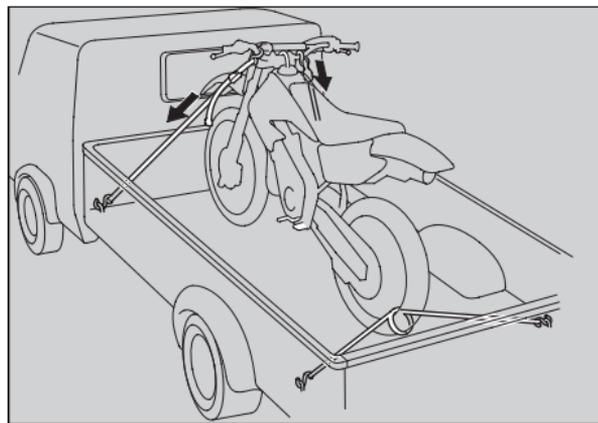
Para fijar el vehículo, ate la rueda delantera a la parte frontal de la plataforma de carga del camión o del riel del remolque. Enganche los extremos inferiores de dos cintas a los ganchos de retención de la plataforma de carga del camión o del riel del remolque. Enganche los extremos superiores de las cintas al manillar (uno en el lado derecho y el otro en el izquierdo), cerca de la horquilla.
