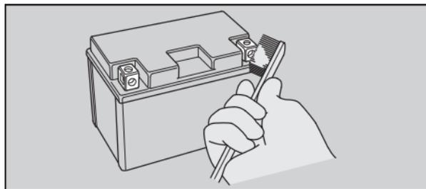
4. Tras la limpieza, vuelva a instalar la batería. La batería dispone de una vida útil limitada. Consulte con su concesionario el momento de sustituir la batería. Sustitúyala siempre por otra batería de iones de litio del mismo tipo.
